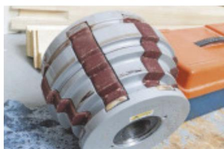
Schleifwerkzeug für das innere Blendrahmenprofil ...
