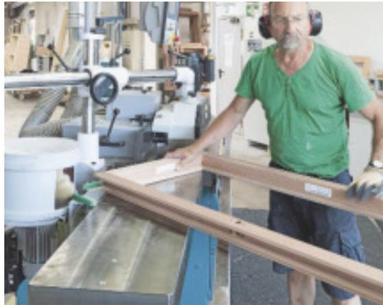
... dreht dann den Flügel leicht, um die Kanten der Ecke an der rotierenden Schleifbürste zu brechen
