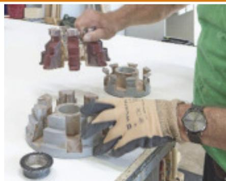
In der rechten Hand hält der Maschinenführer das eigentliche Schleifwerkzeug, in der linken den Flankenschutz
